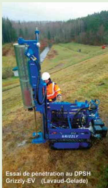
Pénétromètre dynamique instrumenté servo-assisté à énergie variable Grizzly-EV.
