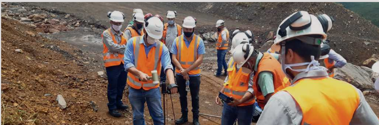
Essais de contrôle pour la vérification du potentiel de liquéfaction au pénétromètre dynamique à énergie variable.
