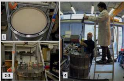
Essais au laboratoire en chambre d'étalonnage Ko (ENPC, Laboratoire Navier) dans le cadre des études pour le développement d'une méthodologie pour l'évaluation du potentiel à la liquéfaction.
