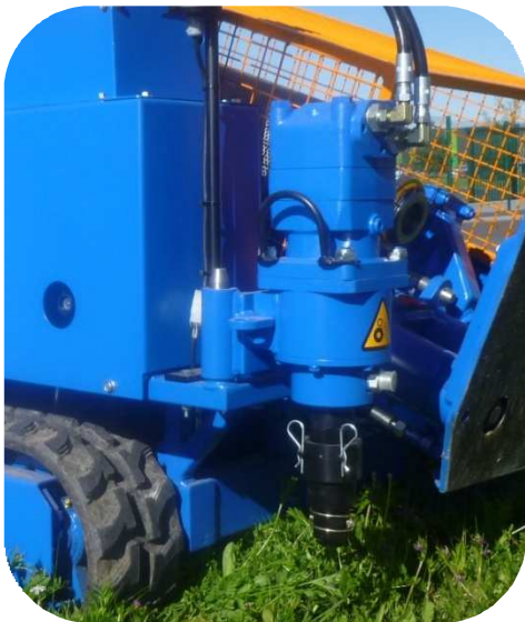
Tête de forage en position de transport
